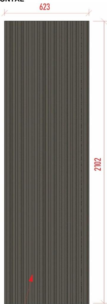
Painel ripado em MDF de 15mm. Com frisos em MDF de 18mm de largura cada e 25mm de espaçamento entre eles
