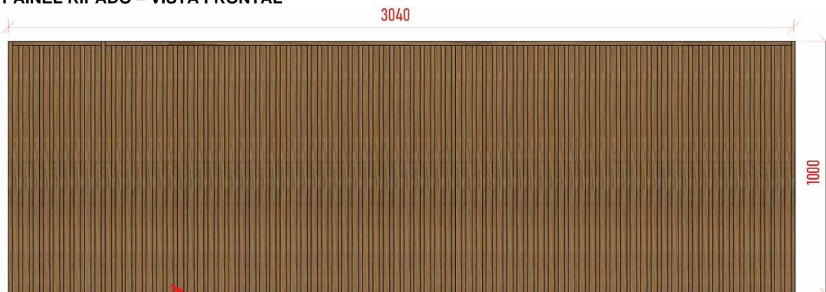
Painel ripado em MDF de 15mm. Com frisos em MDF de 18mm de largura cada e 25mm de espaçamento entre eles
